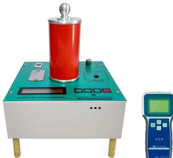
AI-6201W是RC串联型标准介损器。采用数控方式切换电阻，操作非常方便，在 $\pm 2^{\circ}\text{C}$ 范围可以做到较高的重复性。0~10%之间有30个档位，最高工作电压10kV。配有红外遥控接收器，可遥控切换档位，安全可靠。
