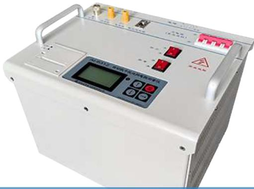
AI-6312接地装置工频特性参数测试系统用于现场抗干扰接地电阻等特性参数测量，由AI-6312自动抗干扰地网电阻测量仪、隔离变压器、AI-7301选频电压表组成。可以外接高精度钳形电流传感器和罗氏线圈电流传感器，实现选频分流测量。采用变频抗干扰和傅立叶变换数字滤波技术，全自动智能化测量，强干扰下测量数据准确稳定。
