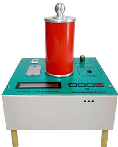
AI-6201是RC串联型标准介损器。采用数控方式切换电阻，操作非常方便，在 $\pm 2^{\circ}\text{C}$ 范围可以做到较高的重复性。0~10%之间有30个档位，最高工作电压10kV。
